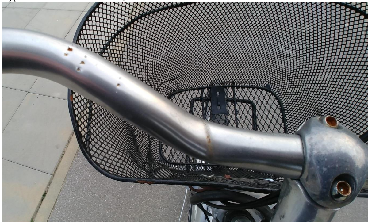
Zdjęcie 3. Uszkodzona kierownica, RRM 60359
