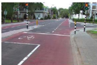
DOBRE: pasy dla rowerów na jezdni - służą umożliwieniu wyprowadzenia samochodów oczekujących na światłach i bezpiecznej skrętu w lewo (De Steeg, Holandia).
